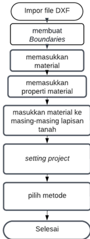
Gambar 4. Diagram alur pembuatan geometri lereng.
