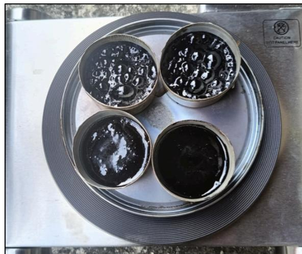
Gambar 3. Pencampuran dan pemanasan bio-aspal
