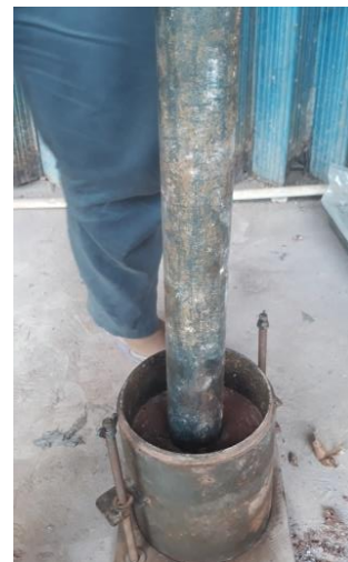
Gambar 4. Pengujian pemadatan tanah
